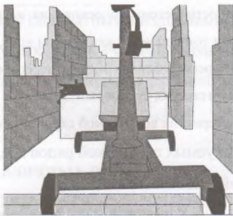
Рисунок 28 – Проемы для передвижения грузоподъемных механизмов
