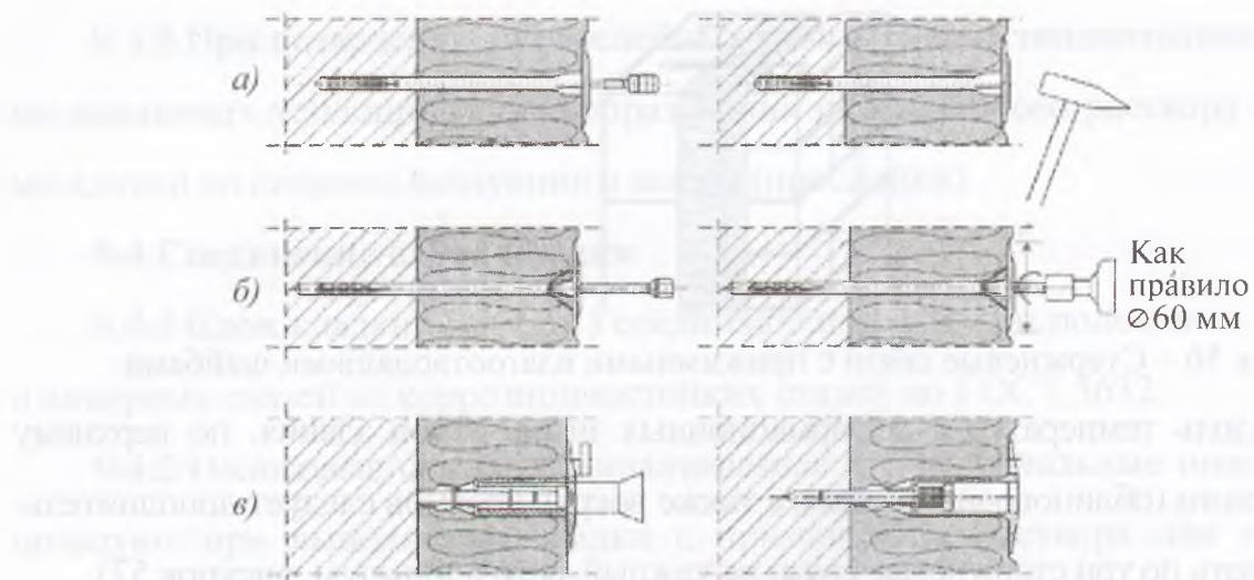
**а)** – дюбель-анкер для забивания; **б)** – дюбель-анкер для вкручивания; **в)** – установочный дюбель-анкер.
