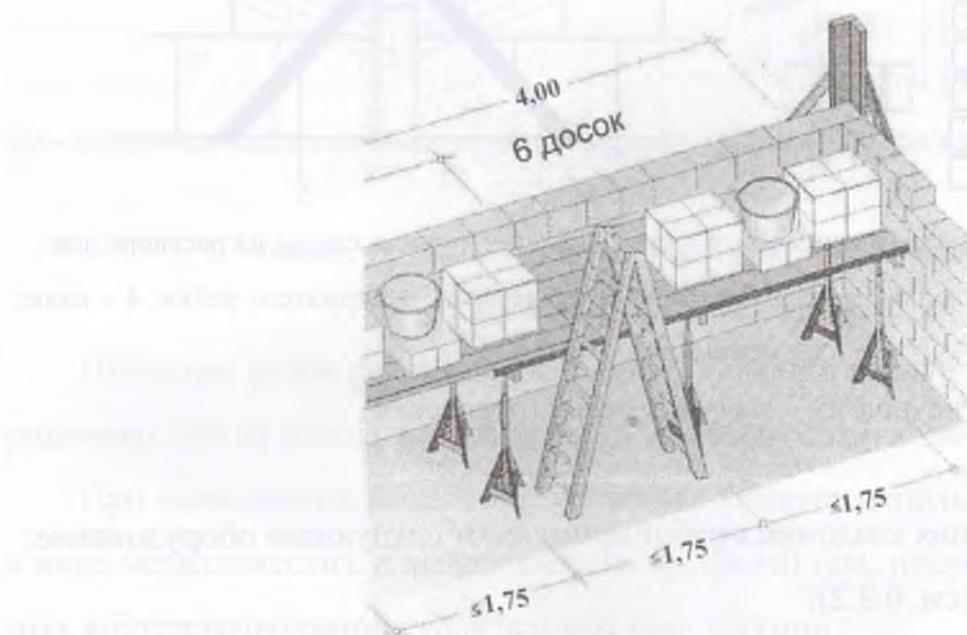
Рисунок 14 – Переставные леса, размеры в м
