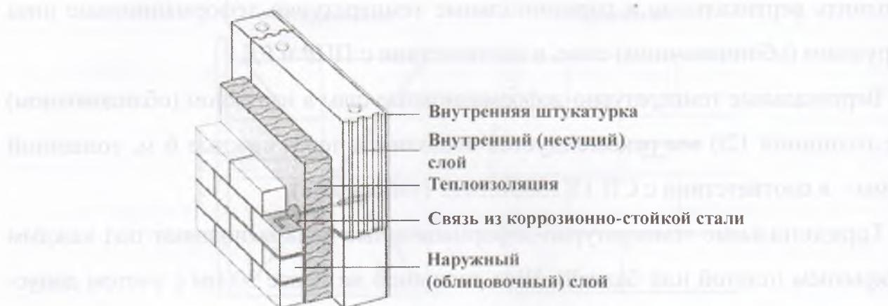
Рисунок 54 – Конструкция со слоем теплоизоляции без воздушного зазора (прослойки
