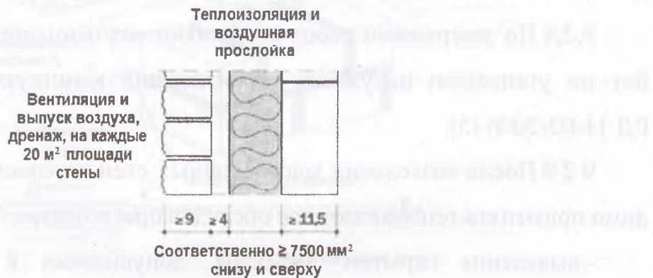
Рисунок 53 – Конструкция со слоем теплоизоляции и воздушным зазором (прослойкой)
