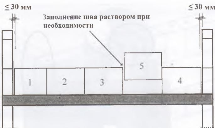
Рисунок 36 – Последовательность кладки блоков и плит перегородочных между параллельными стенами
