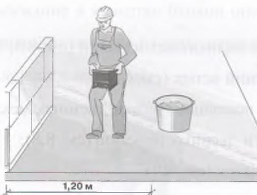
Рисунок 26 – Расстояние между емкостью (чаном) с раствором или kleem и возводимой стеной
