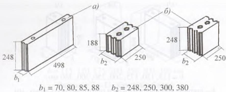
а) – плита перегородочная; б) – блок,  $b_1$  – ширина плиты перегородочной, мм;
