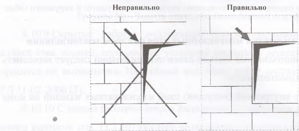
Рисунок 52 – Укладка теплоизоляционных плит по периметру проема
