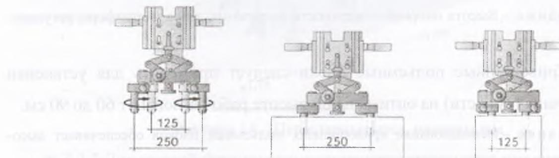
Рисунок 18 – Грейферное захватное устройство, размеры в мм
