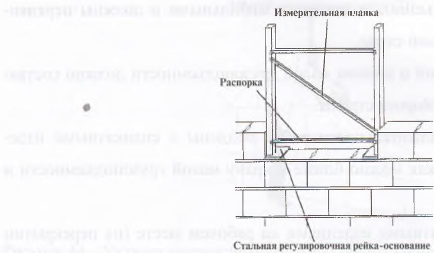
Рисунок 47 – Применение рамки из реек при устройстве оконного проема
