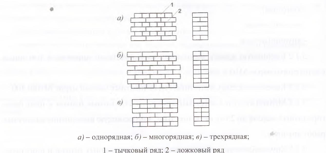
Рисунок 1 – Системы перевязки швов кладки
