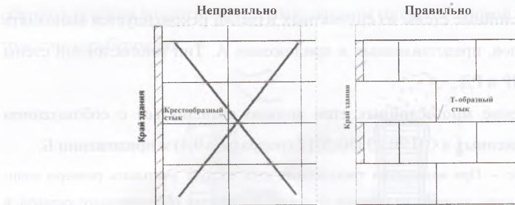
Рисунок 51 – Укладка теплоизоляционных плит с перевязкой (смещением)
