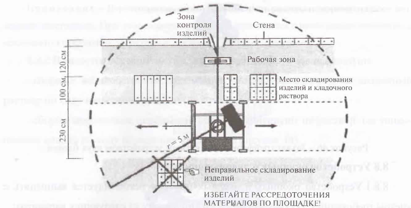
Рисунок 45 – Организация рабочего пространства при использовании кранов малой грузоподъемности
