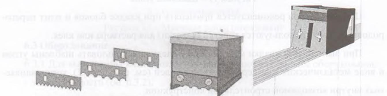
Рисунок 10 – Картинка с описанием и изображением каретки (салазки) для раствора для тонкошовной кладки
