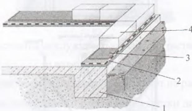
1 – фундамент; 2 – гидроизоляция; 3 – кладочный раствор; 4 – блоки опорного ряда
