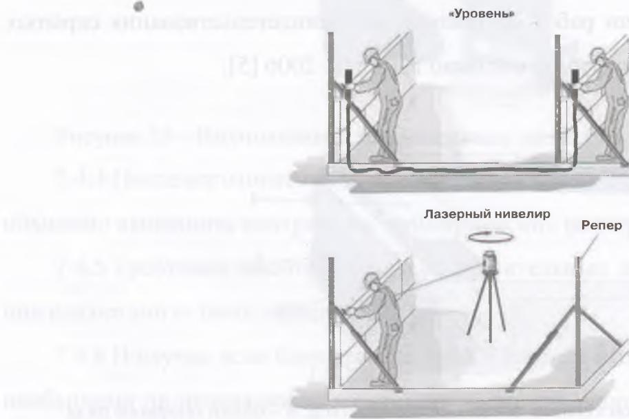
Рисунок 25 – Установка шаблонов углов с помощью шлангового ватерпаса и лазерного уровня
