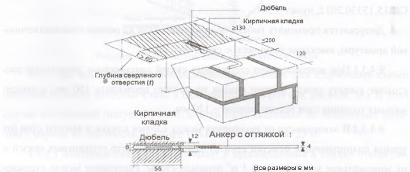
Рисунок 55 – Конструкция без слоя теплоизоляции
